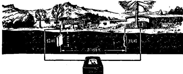
土地电：根据地震会引起地下电流变化的现象，采用简易小巧的土地电办法：在地面选择两点埋入电极，用导线连接并串连一个微安表，观测两点间自然电流变化，就可预报震情。
