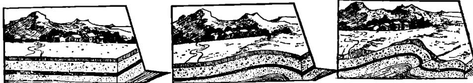
地震，除少数“火山地震”、“陷落地震”外，绝大多数是“构造地震”。这是由于地球经久不息地运动和太阳、月亮等引力的影响，使地壳中的岩层变质、变形，当地球内部受到的巨大力量不断集中、加强，超过了岩层某处的强度时，这岩层就会急剧破裂、错动，引起突然震动，以地震波的形式向各方面迅速传到地面，造成不同程度的破坏。
